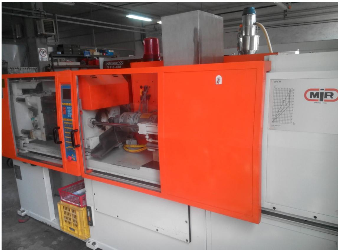
Fig.4.4. Pressa ad iniezione MIR MPO 50
