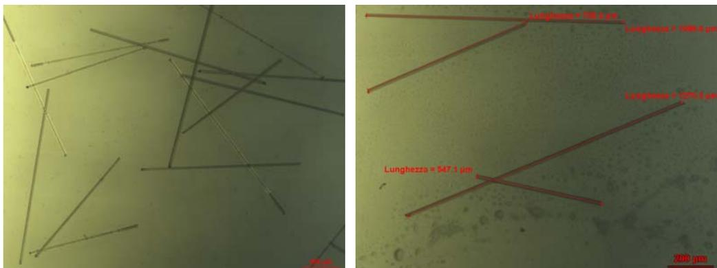
Fig.4.14. Esempio di fibre estratte dalla matrice polimerica (a) con relativa misura della lunghezza (b)
