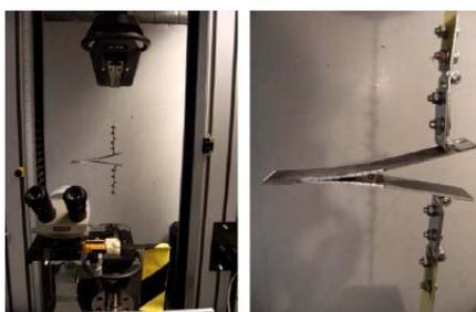
Fig.2.20. Setup sperimentale della prova di delaminazione
