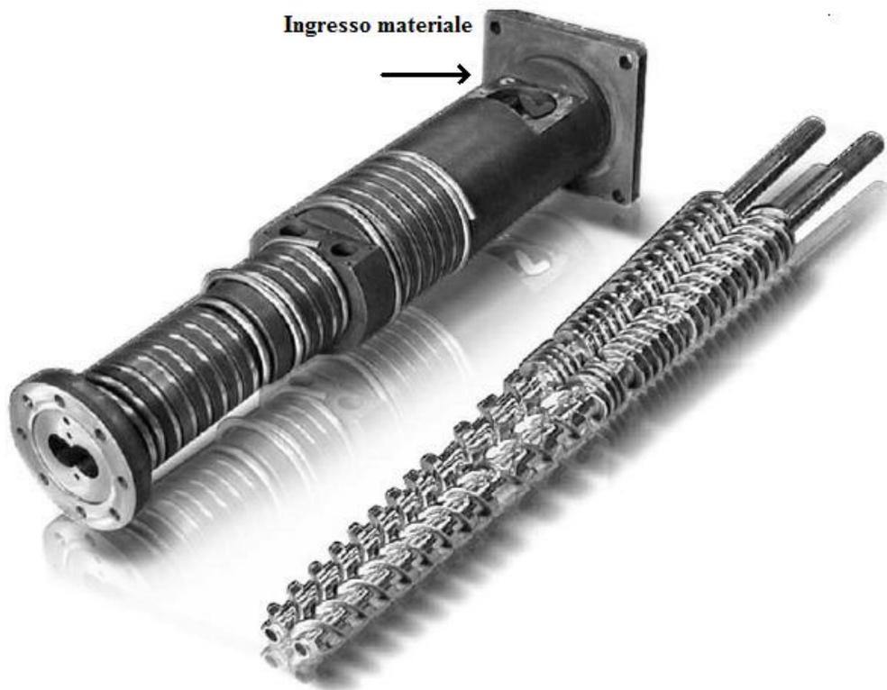
*Fig 1.5. Cilindro di plastificazione e viti senza fine a geometria variabile*
