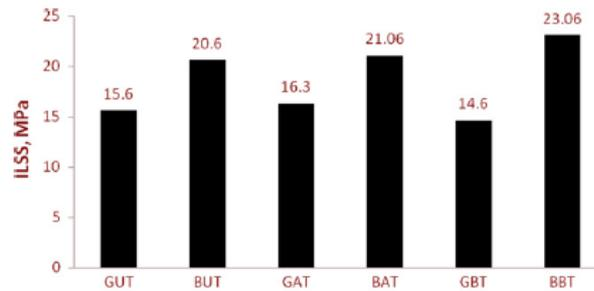
Fig.2.34. Effetto dei trattamenti chimici sulla resistenza a taglio interlaminare dei compositi in fibra di basalto e vetro-E
