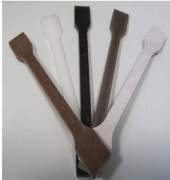
*Fig.4.8. Geometria dei campioni per le prove di trazione e particolare fotografato di alcuni di essi*
