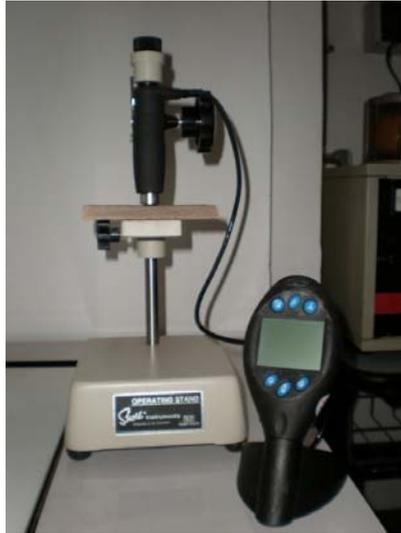
Fig.4.11. Durometro Shore modello S1
