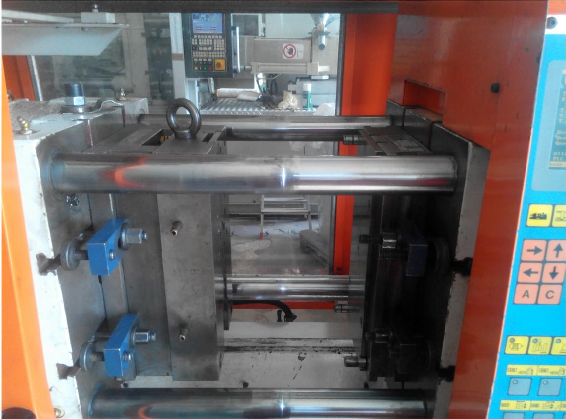
*Fig.4.7. Stampo montato sulla pressa*
