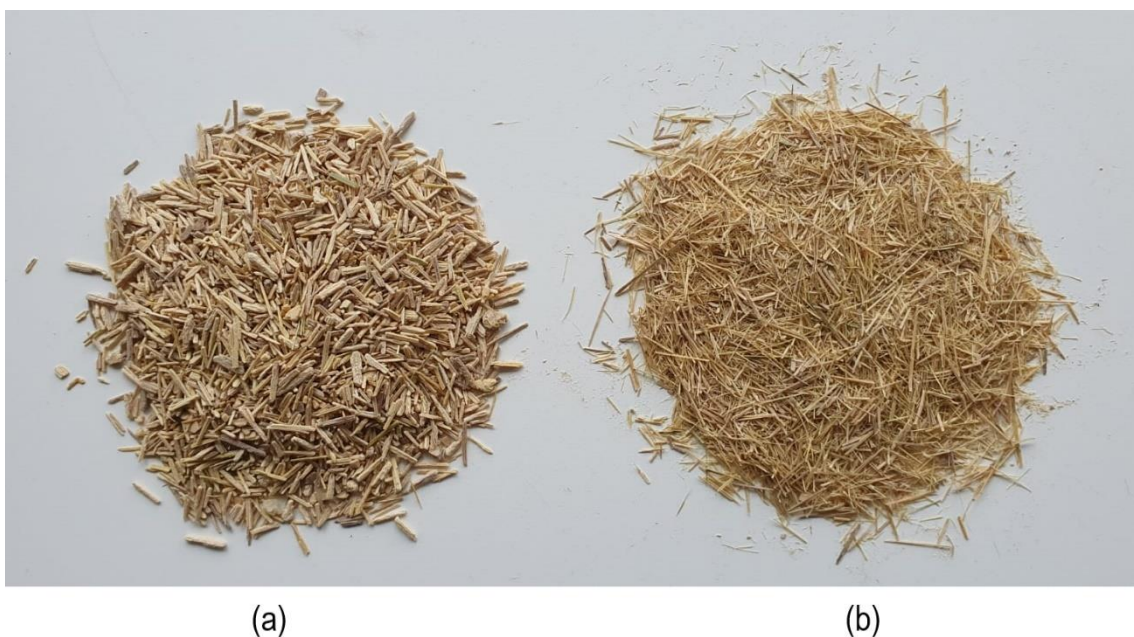
Figura 1 - Confronto tra scarti di macerazione (a) e fibra fine (b)
